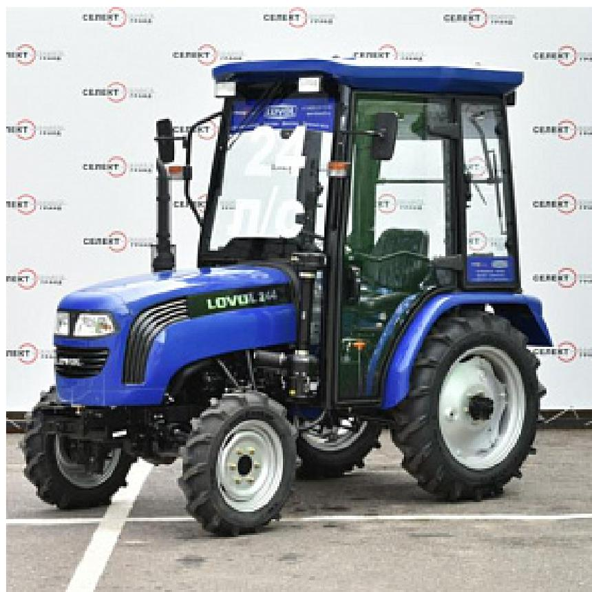
Трактор LOVOL TE404 G2, от признанного лидера в тракторостроении, является универсальным колесным трактором. Он предназначен для широкого спектра различных работ. Оснащен 4-х цилиндровым дизелем с водяным охлаждением мощностью 40 л.с., задними ВОМ на 8 шлицов 540/1000 об/мин, 3-х точечной навеской 1 кат., а так же двумя парами гидро-выходов. Поставляется с интегрированной кабиной с отопителем.
