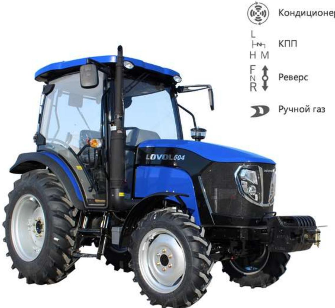
Трактор LOVOL TB604 G3 – трактор с расширенными возможностями. Версия 3й генерации, включающая не только новый дизайн и улучшенные показатели комфорта, но и совершенной новый уровень технического оснащения и безопасности оператора. Оборудован 4-х цилиндровым дизелем с водяным охлаждением мощностью 60 л.с., задними ВОМ на 8 шлицов 540/1000 об/мин, 3-х точечной навеской 2 кат., а так же двумя парами гидро-выходов. Кондиционером и отопителем кабины.
